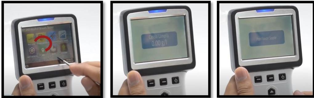
5. Indique al usuario que sople de manera fuerte y constante sobre la boquilla. El dispositivo emitirá un sonido constante mientras toma la prueba, también se puede mostrar una barra de carga en pantalla hasta que muestre el resultado cuantitativo.
