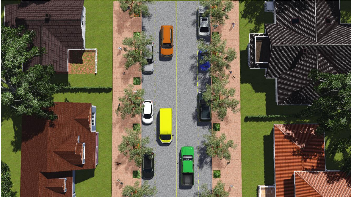
Gráfico 9: Elementos de una vía colectora, vista aérea.
