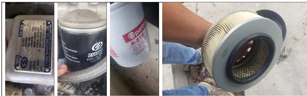
Figura 13. Repuestos para el mantenimiento preventivo del grupo electrógeno.
